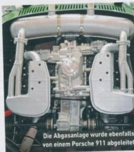
Der Vierzylinder-Boxer wird über zwei Weber-Doppelvergaser beatmet und leistet 170 PS
